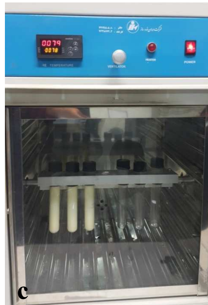
شکل ۳-۲. دستگاه Rotospin: (a) نمای کلی، (b) دستگاه محتوی پیپت و (c) دستگاه محتوی لوله آزمایش
